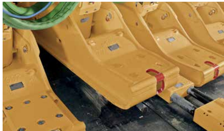
«Шаг слона» — Функция подъема одной лыжи основания при передвижке секции крепи
