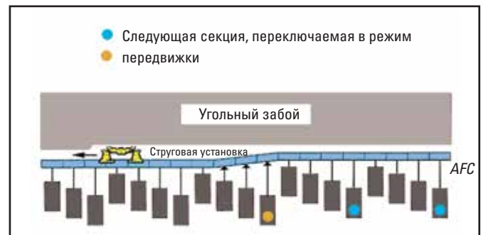
Принцип пошагового метода резания стругом
