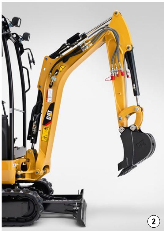
Готовые к эксплуатации быстроразъемные соединения в стандартной комплектации оснащаются автоматической защелкой, которая упрощает и ускоряет открывание соединений и смену оборудования. Соединения расположены рядом с навесным оборудованием, что позволяет использовать шланги меньшей длины и снижает до минимума риск повреждений.
