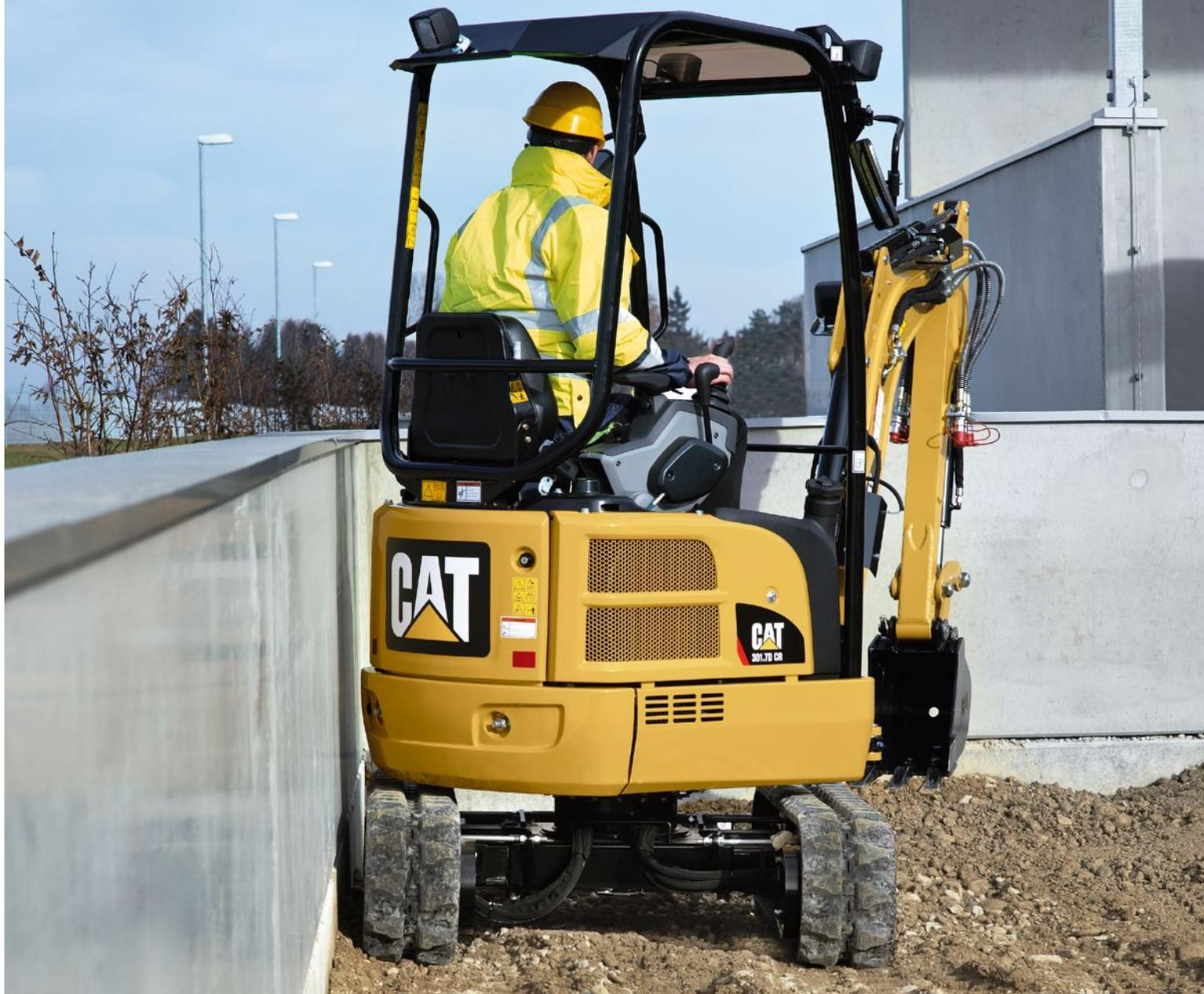
Экскаватор Cat 301.7D CR с нулевым вылетом задней части может отлично работать в условиях ограниченного пространства, т. к. поворотная платформа машины способна поворачиваться без вылета за пределы гусеничной ленты. Конструкция с малым радиусом поворота позволяет оператору сосредоточиться на выполнении работы, не беспокоясь о возможности повреждения задней части машины и других объектов, расположенных на рабочем участке.
