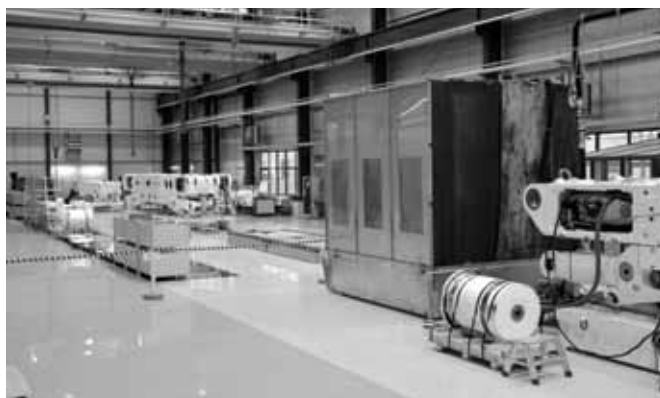
Три очистных комбайна на разных этапах изготовления: от очистного комбайна, готового к оснащению (слева), до комбайна, успешно прошедшего все испытания и подготавливаемого к отправке (справа).
