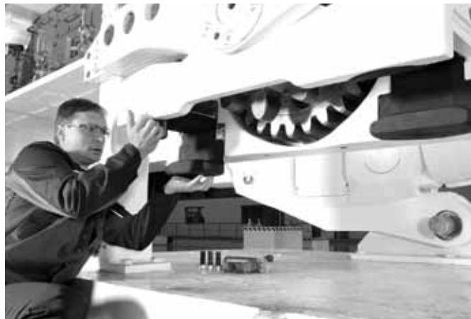
Захватная лыжа со сменной вставкой обеспечивает длительный ресурс, более универсален, безопасен, быстрее заменяется и удобнее для замены изношенных деталей.
