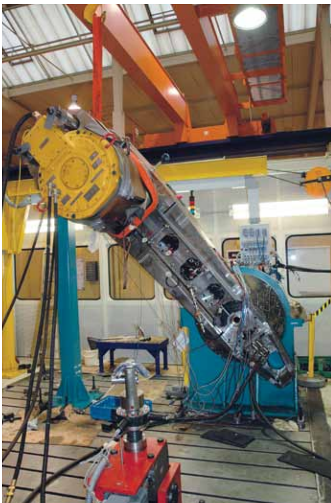
Проверка смазочной системы в наиболее неблагоприятных условиях
