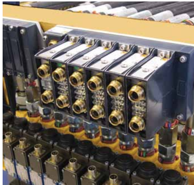
Искробезопасный модуль CIOS™ с современной локальной сетью Ethernet
