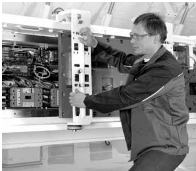
Надежная основная рама защищает распределительные коробки от влияния сил резания и подачи. Система управления дверью обеспечивает быстрый доступ к электрическим шкафам.
