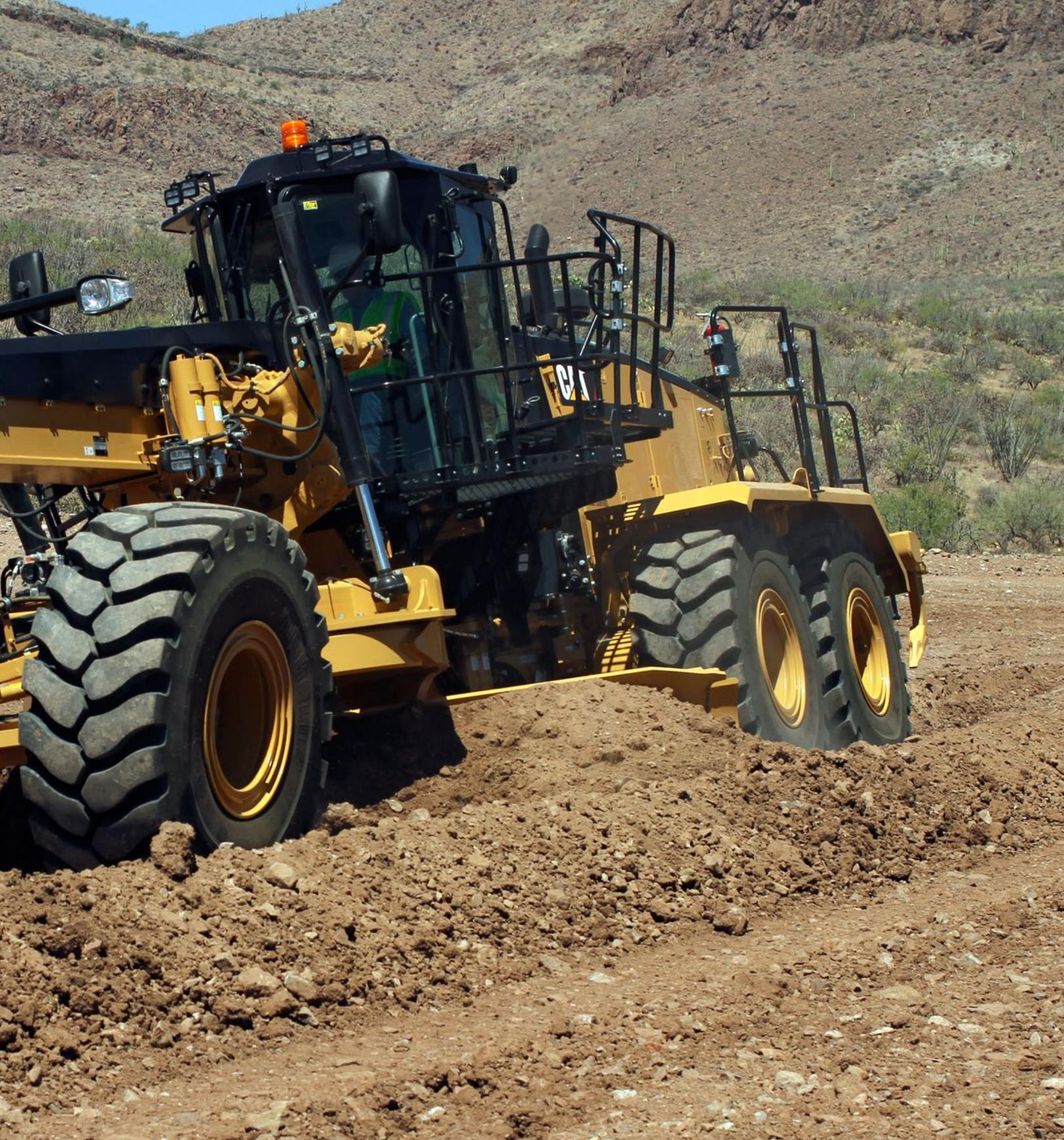
**Хорошее состояние дорог является ключевым условием для увеличения срока службы самосвалов, снижения объемов технического обслуживания, сокращения расходов на топливо и снижения повреждения шин. В результате увеличивается продолжительность цикла, повышается объем добычи руды при снижении затрат.**
