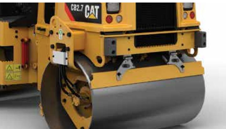
**Защитите свою технику. Передний и задний бамперы защитят каток от ударов о препятствия, а складные скребки вальцов снизят их износ при перемещении машины по площадке.**
