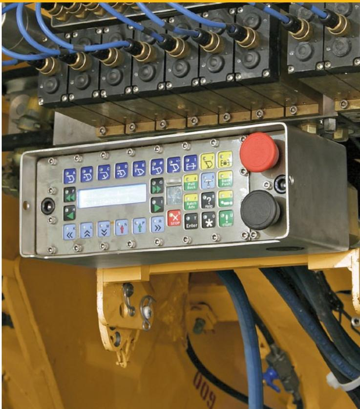
Компания Caterpillar производит полный спектр систем управления механизированной крепью, от ручных гидравлических органов управления до хорошо зарекомендовавшей себя системы электронного управления PMC-R для самой современной автоматизации работы в забоях и контроля оборудования.
