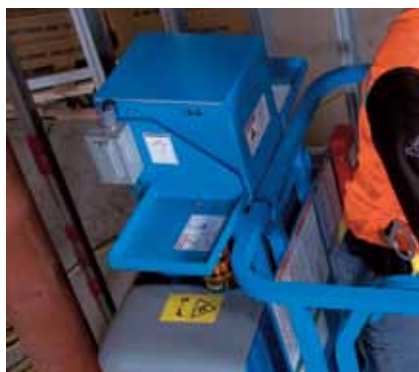
Полка для инструмента платформы подъемника Runabout Contractor
