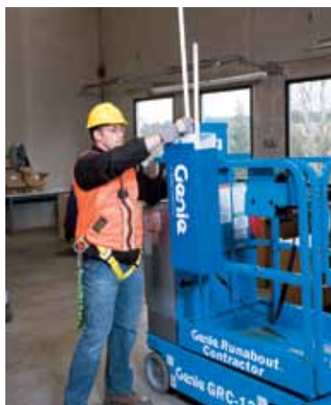
Футляр для люминесцентной лампы (только для моделей с узкой и стандартной платформой)
