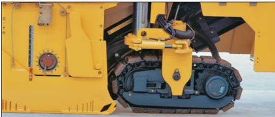
**Срезание заподлицо.** Правая задняя гусеница машины поворачивается в пределах ширины реза машины, что позволяет использовать агрегат для операций срезания заподлицо. Когда правая задняя гусеница повернута вовнутрь, машина может выполнять срезание вблизи стен, ограждений и других вертикальных препятствий.
