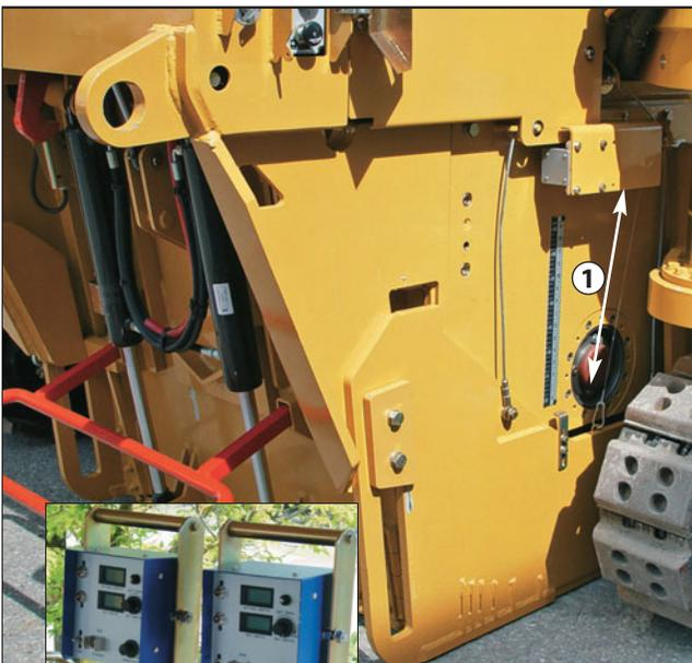
**Проводные контактные датчики уклона.** Проводной датчик уклона измеряет перемещение боковой пластины – это позволяет превратить боковую пластину по всей ее длине в инструмент для выравнивания для точного измерения уклона при выравнивании. Датчик поперечного уклона обеспечивает еще большую гибкость системы.
