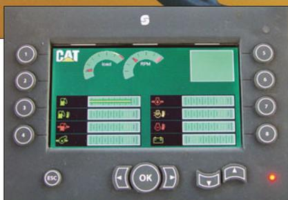
Большой дисплей отображает рабочие параметры для диагностики машины и двигателя. (На рисунке показан цветной дисплей, устанавливаемый по отдельному заказу.)
