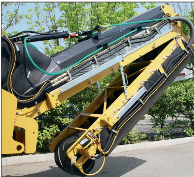
**Складной транспортер.** Транспортировка машины облегчается за счет складного переднего транспортера, который позволяет уменьшить габариты машины.
