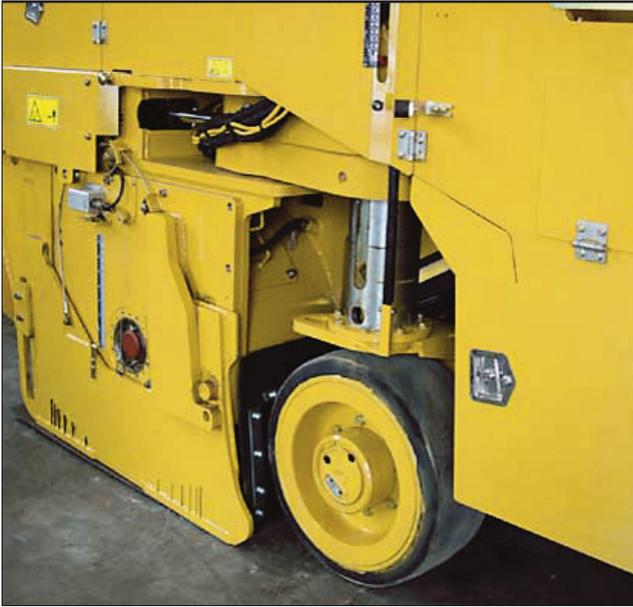
**Максимальное тяговое усилие.** Гидростатический привод на все четыре колеса через делитель потока, а также самовыравнивающийся передний мост обеспечивают повышенное тяговое усилие и оптимальную производительность при выполнении любых работ.
