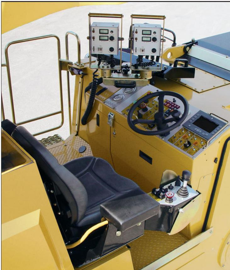
**Эргономичный пост оператора.** Пост оператора по всей ширине машины обеспечивает обзор переднего погрузочного транспортера и боковых пластин для точного и быстрого позиционирования.
