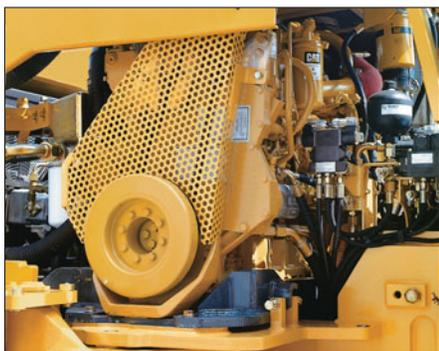
*Большие панели моторного отсека обеспечивают свободный доступ к двигателю и компонентам гидравлической системы на уровне земли.*
