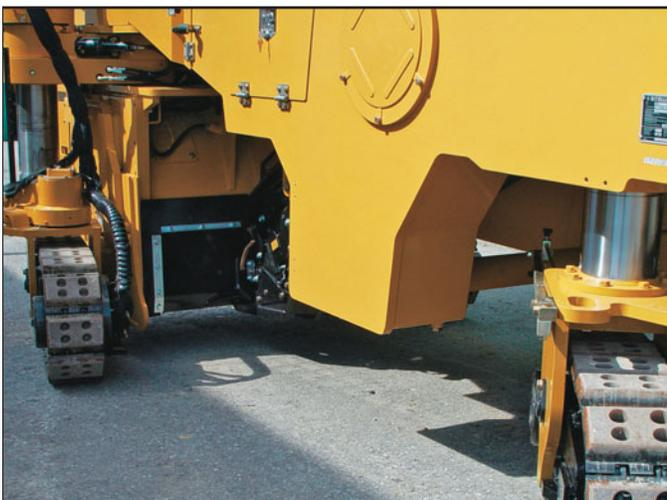
**Точное управление.** Управление углом поворота правой задней гусеницы осуществляется с помощью микропроцессора. Угол поворота правой задней гусеницы автоматически регулируется относительно положения передних гусениц.
