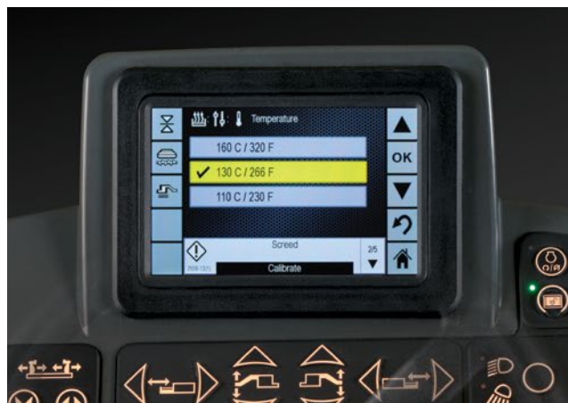
Три заданных варианта нагрева обеспечивают широкий диапазон температур для различных типов смесей
