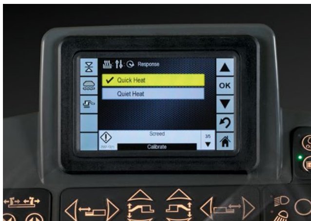
Простой выбор постепенного или быстрого нагрева при помощи ЖК-дисплея. Режим быстрого нагрева экономит время при использовании комплектов для увеличенной ширины укладки.
