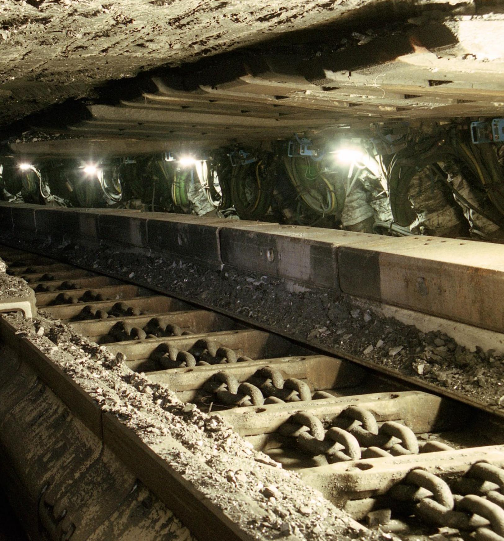
**Струговая система Gleithobel GH1600 специально предназначена для очень твердого угля и обеспечивает высокую производительность за счет удвоения установленной мощности GH800 до 1600 кВт (1080 hp). Ее можно использовать для пластов от примерно 1,0 м до 2,53 м с устьем.**
