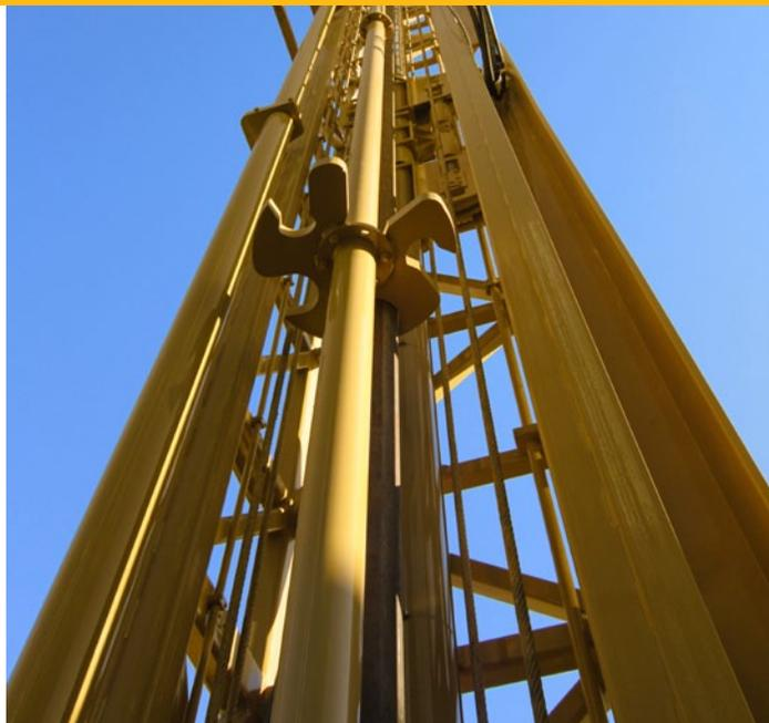
Для обеспечения длительного срока службы все конструкции мачты оснащены двойной обвязкой в зонах повышенных механических напряжений. Имеются несколько специальных конфигураций мачты.
