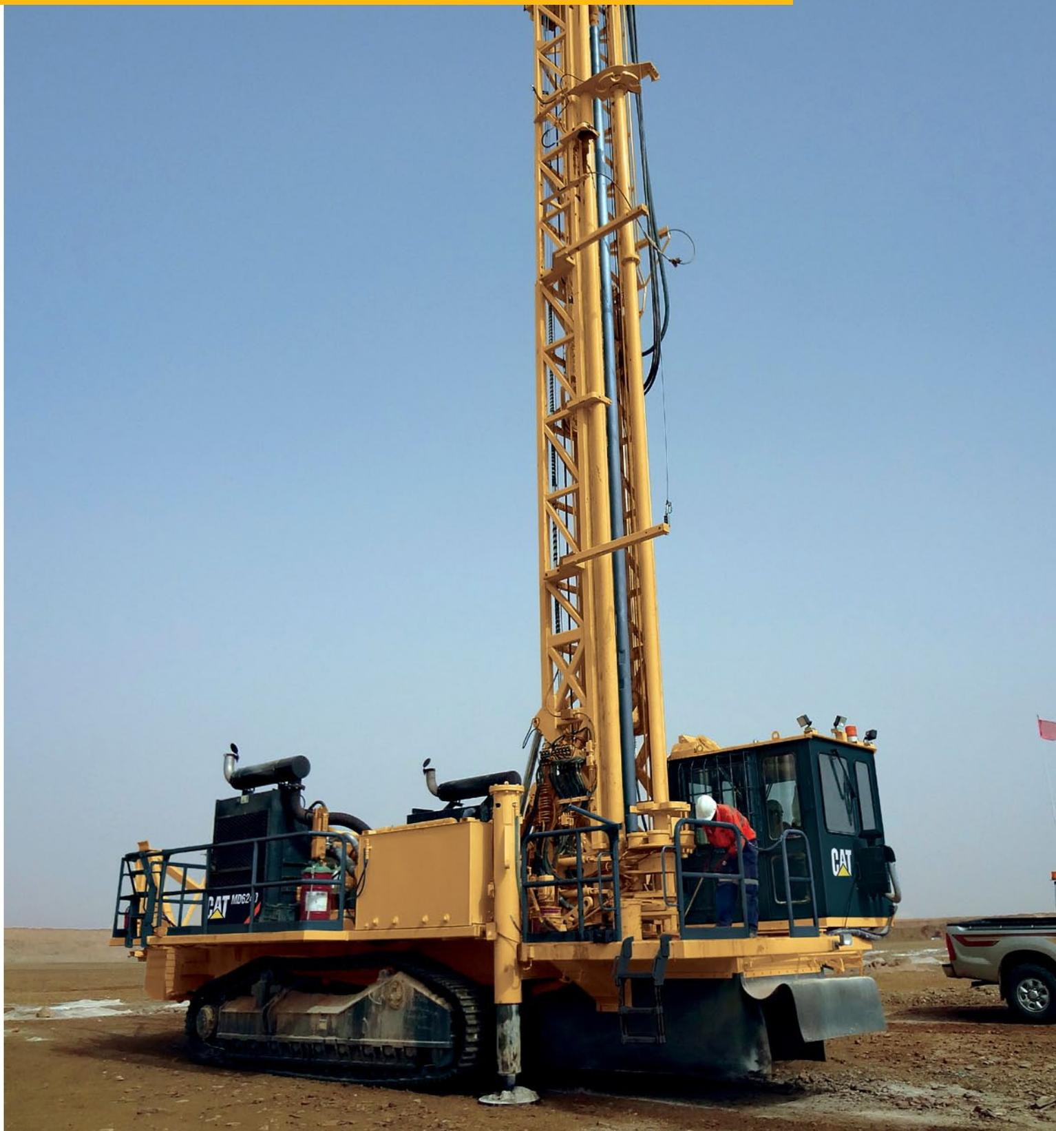
Для обеспечения долгого срока службы машина MD6240 оснащена усиленными несущими конструкциями. Мачта, встроенная А-образная рама и главная рама образуют прочную конструкцию, способную выдержать нагрузки при бурении в сложных условиях. Машина MD6240 предназначена для самых тяжелых работ и обладает высокой технической готовностью, что способствует повышению прибыльности владельца.
