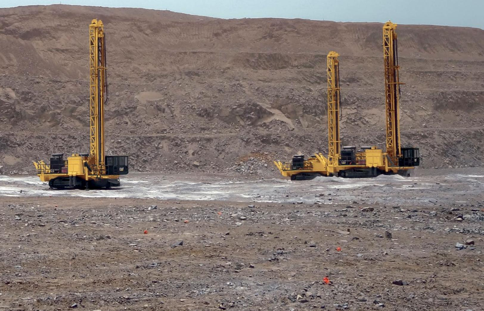
Роторные буровые станки MD6240 обладают высокой производительностью и обеспечивают низкие эксплуатационные затраты. Благодаря нагрузке на долото 24 000 кг и максимальной глубине бурения до 55,47 м буровые станки MD6240 прекрасно подходят для бурения твердых и мягких скальных пород. При проектировании машины главными критериями являлись надежность, безопасность и удобство технического обслуживания.
