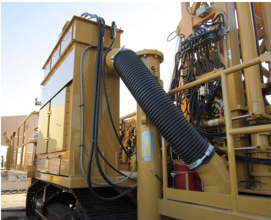
Для эффективного сбора пыли машина MD6240 оснащена пылеуловителем, рассчитанным на расход 127 м<sup>3</sup>/мин и отдельной водяной системой подавления пыли. Буровой станок может одновременно оснащаться как сухой, так и водяной системой подавления пыли.
