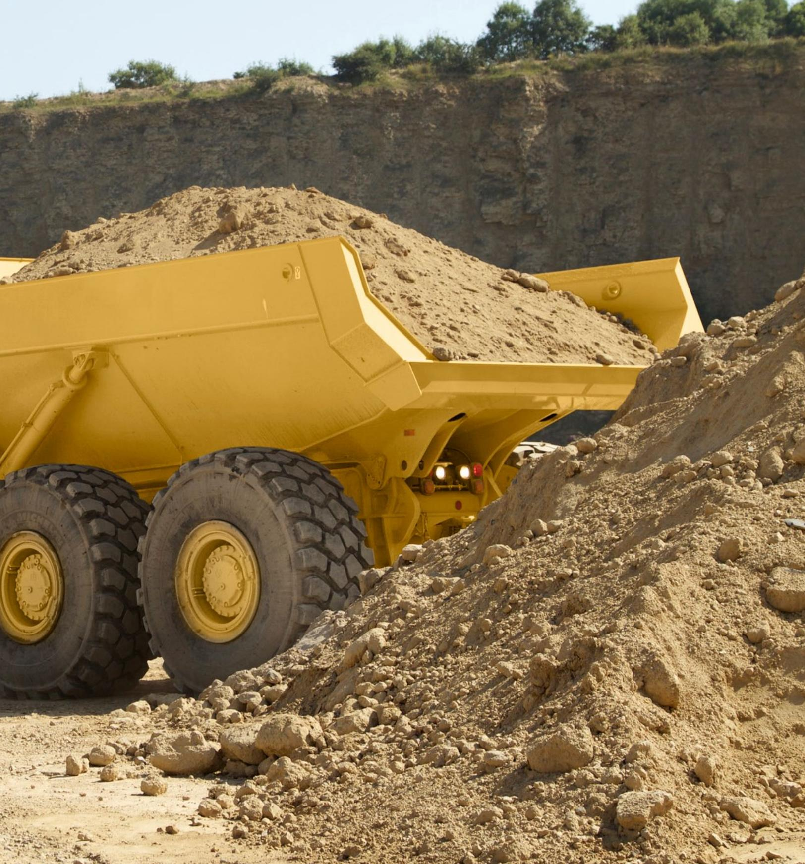
**Машина Cat 735C с вместимостью 22 м<sup>3</sup> и грузоподъемностью 32,7 метрической тонны обеспечивает высокие показатели надежности, прочности, производительности, исключительный комфорт оператора и снижение эксплуатационных расходов.**
